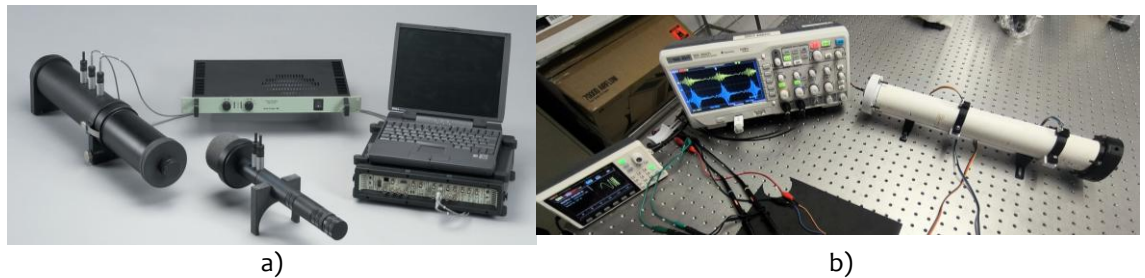
Figura 1. Tubos de impedancia acústica comercial y propuesto. a) Tubo de impedancias acústicas modelo 4206 de Brüel & Kjær®. Imagen tomada del catálogo en línea del fabricante. b) Tubo de impedancias acústicas diseñado.
