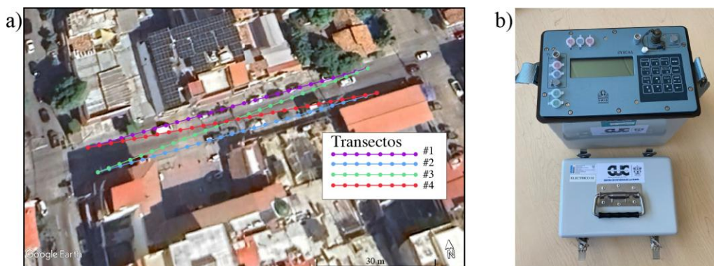
Figura 5. a) Ubicación de los transectos y posición de los electrodos. Los transectos #1 y #2 se realizaron paralelos a las aceras norte y sur, respectivamente, mientras que los transectos #3 y #4 cruzan de sur a norte y de norte a sur, respectivamente. b) Resistivímetro utilizado SYSCAL JUNIOR.
